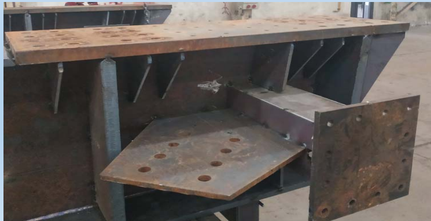
شکل ۱۰-۴-۱۲ رواداری سوراخ‌های پیچ
