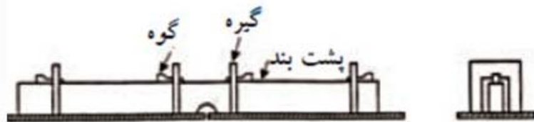
الف- استفاده از پشت بند و گیره و گوه برای هم‌راستایی ورق‌ها
