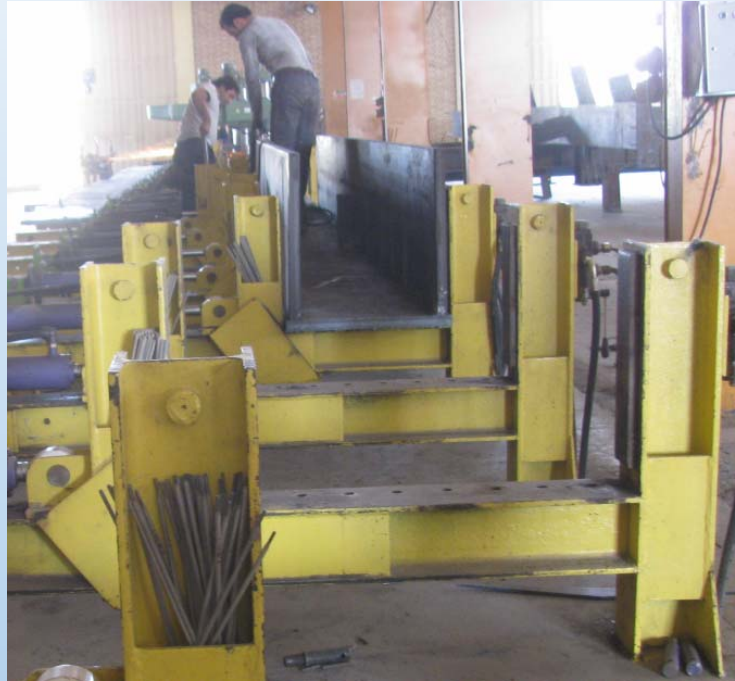
مونتاژ باکس با فیکسچر با جک های طولی
