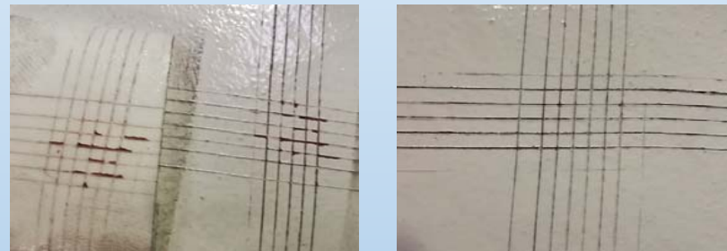
نمونه شبکه برش متقاطع در روش کراس کات
