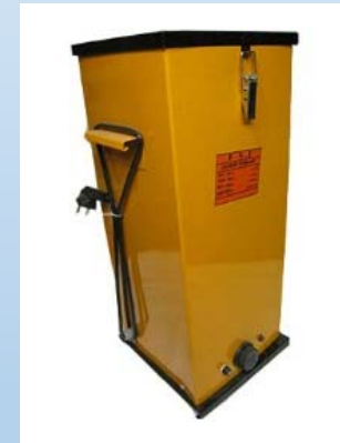
دستگاه خشک کن (آون) الکتروود ۱۰ کیلوئی
