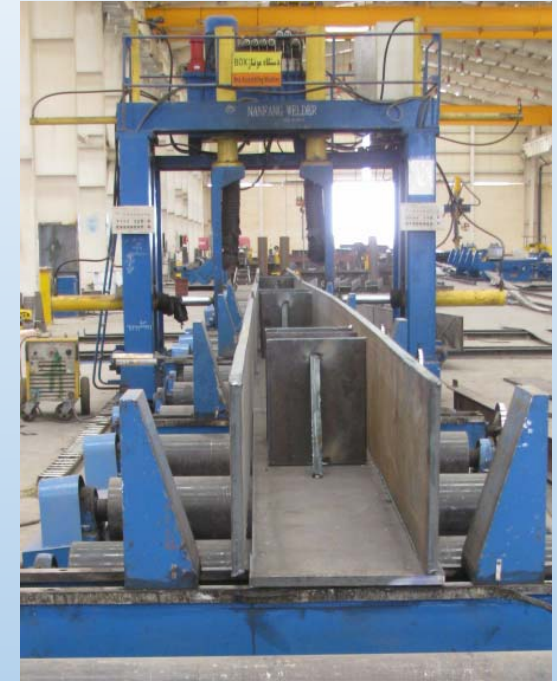
مونتاژ باکس با فیکسچر تک جک
