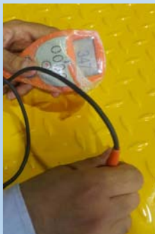
دستگاه الکومتر جهت کنترل ضخامت رنگ
