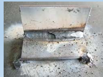
اسپتر حاصل از جوش برق
