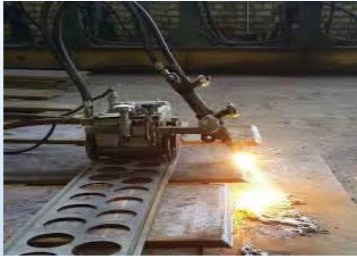
پخ زنی و آماده کردن لبه ها با برش ریلی
