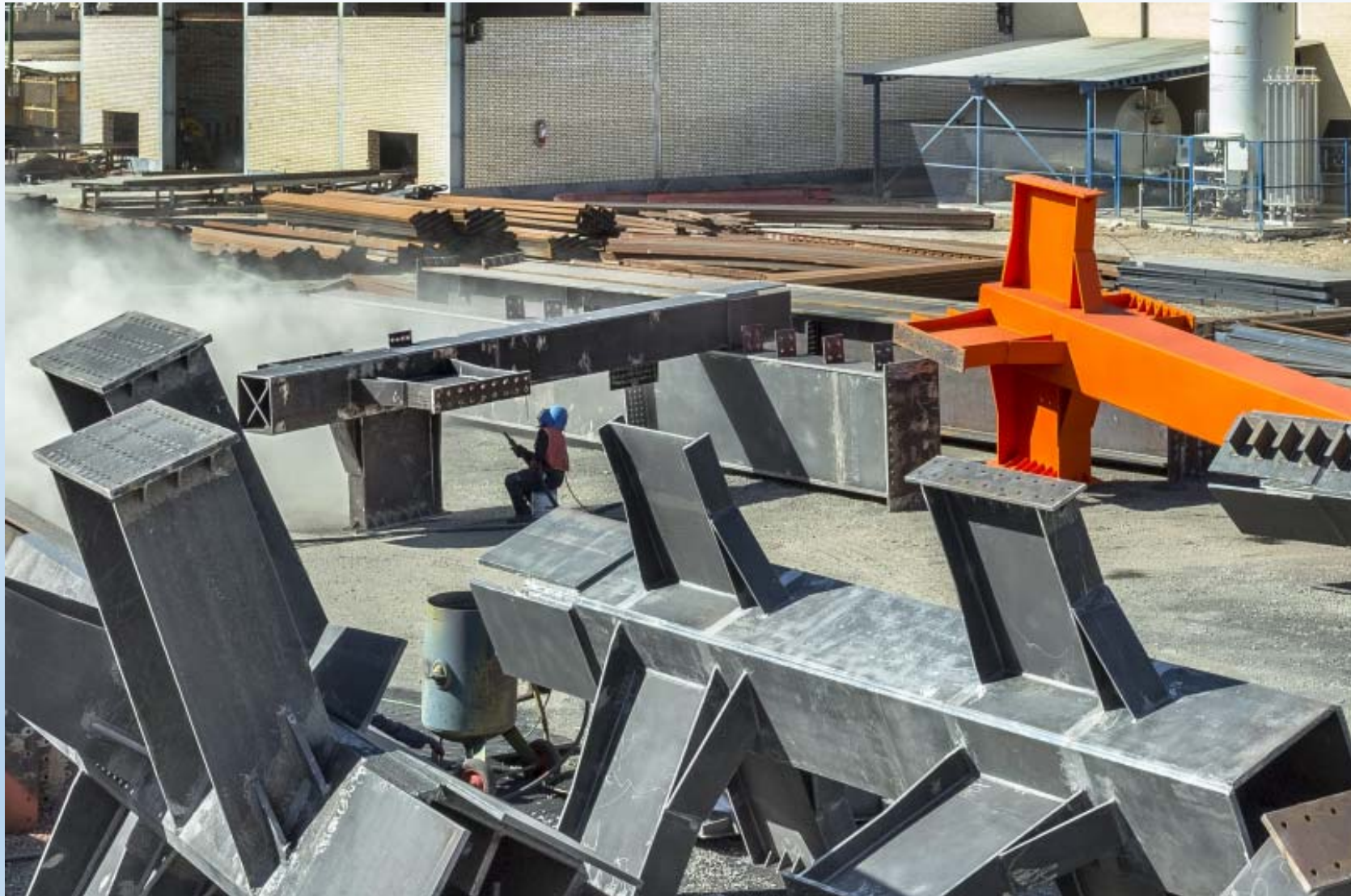
بلاستینگ تا حد نزدیک فلز سفید : SA 2 1/2
