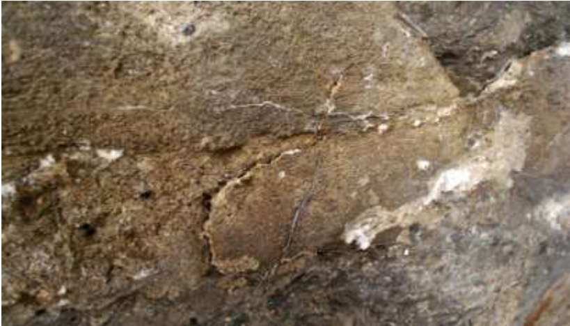
شکل ۲-۵۳- آغاز هوازدگی و پوسته شدن سنگ نامرغوب (خدابنده، ۱۳۸۹)
