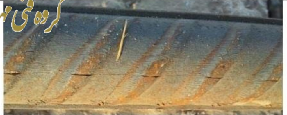
شکل ۵ ترک طولی میلگرد قطر ۳۲
