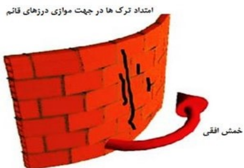
شکل ۲۲- شکست خمشی دیوار در راستای قائم
