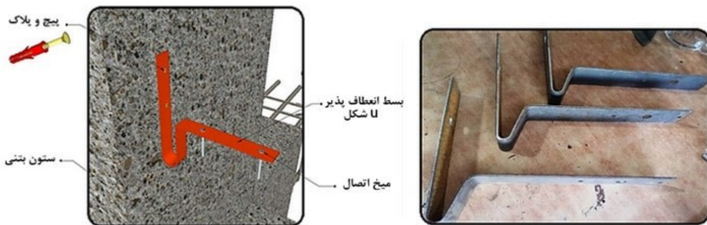
شکل ۶۱- بست رادیکالی و اجزای آن
