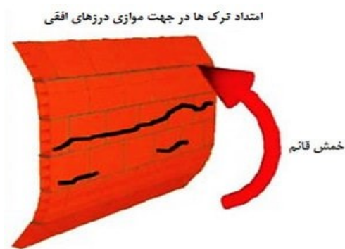
شکل ۲۱- شکست خمشی دیوار در راستای افق
