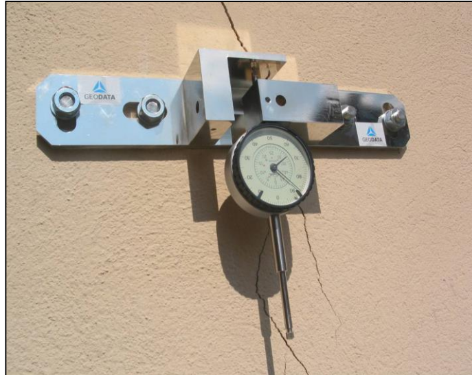
شکل ۵-۱۰ ترک‌سنج دو بعدی با گیج قرائت عقربه‌ای
