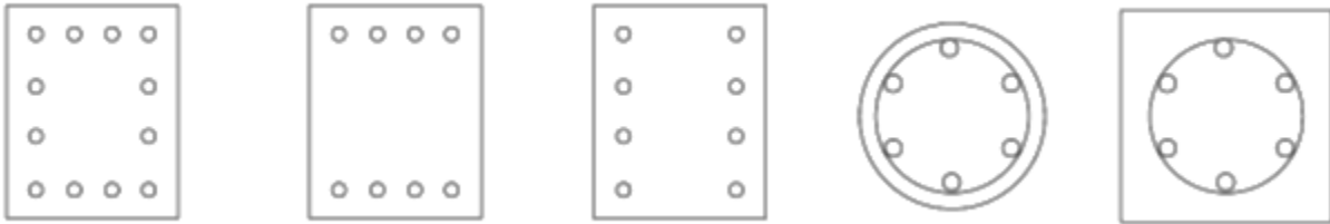
ستون تنگدار با فولاد چهارطرف ستون تنگدار با فولاد دو طرف ستون تنگدار با فولاد دو طرف ستون مارپیچ دار دایره ستون مارپیچ دار مربع
