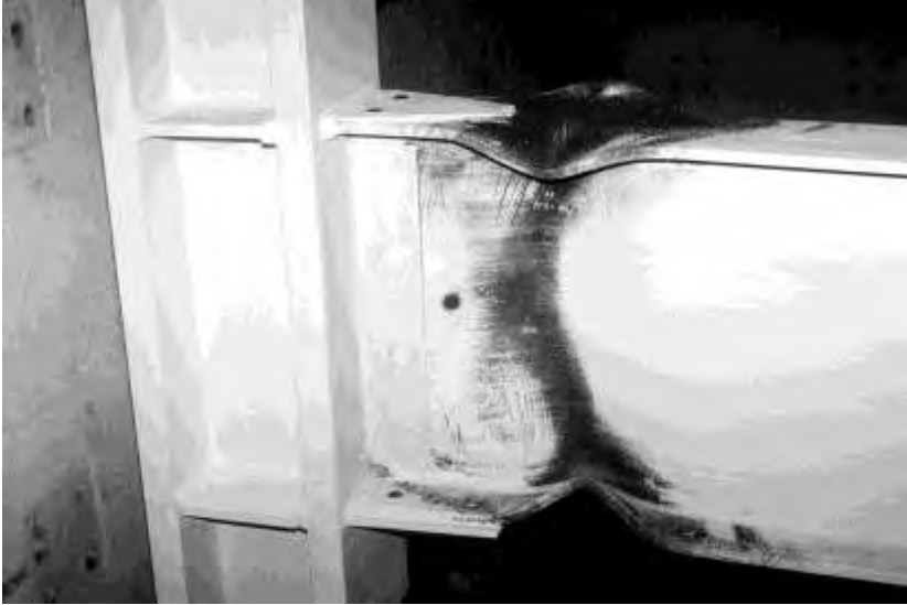
شکل ۳-۸ کمانش موضعی در مکانی که انتظار رفتار غیرارتجاعی وجود دارد
