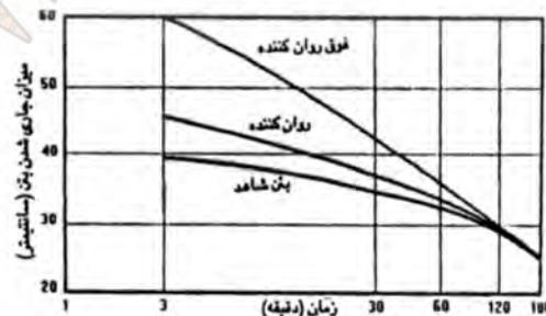
شکل ۱۹- اثر زمان اختلاط بر عملکرد روان کننده ها و فوق روان کننده ها
