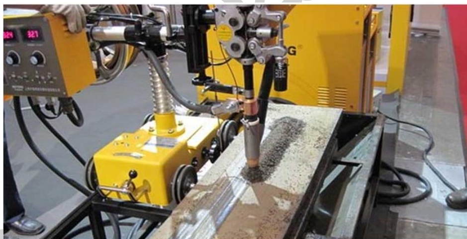
شکل ۱۲-۲- جوشکاری قوسی زیرپودری
