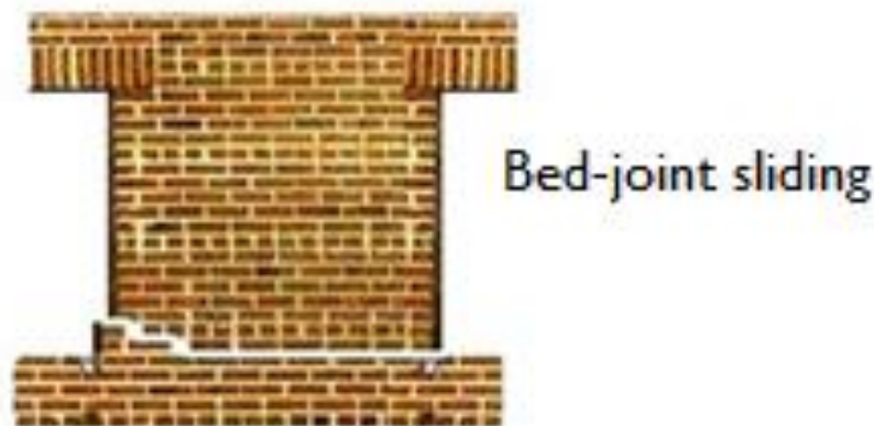
الف) مود شکست بر اثر لغزش درز ملات
