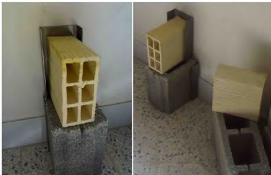
• دو نوع بلوک مورد استفاده در دیوار چینی
