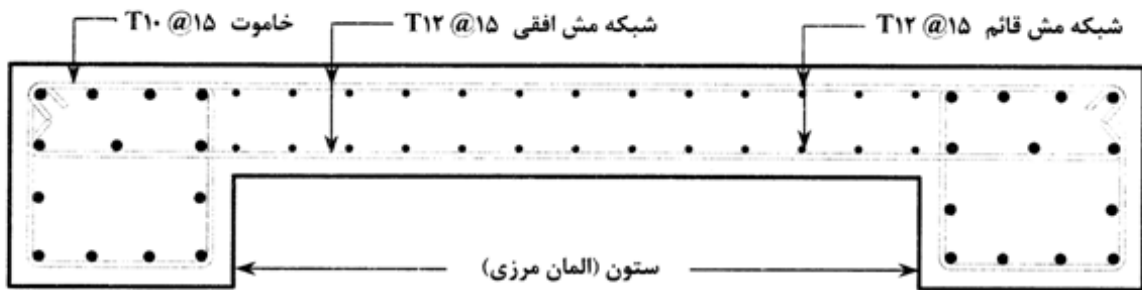
ب) پلان از مقطع دیوار برشی متصل به ستون بتنی طرفین
