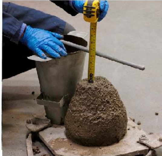
نحوه اندازه‌گیری اسلامپ بتن (کارایی)
