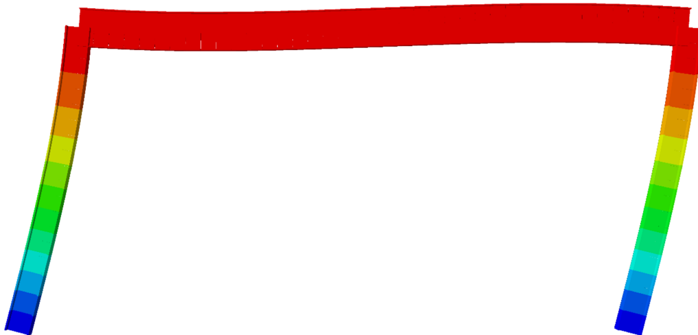
تغییر شکل قاب خمشی پس از اعمال بار وزن و نیروی جانبی
