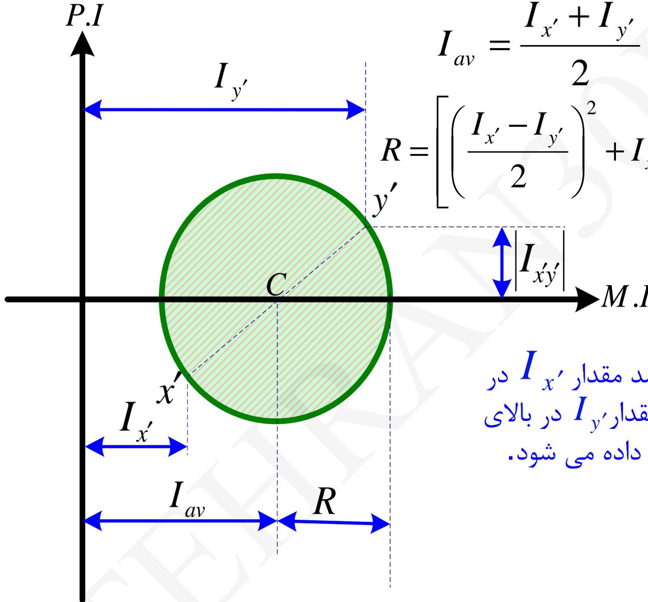
اگر  $I_{x'y'} < 0$  باشد مقدار  $I_{x'}$  در پایین محور افقی و مقدار  $I_{y'}$  در بالای محور افقی نمایش داده می شود.
