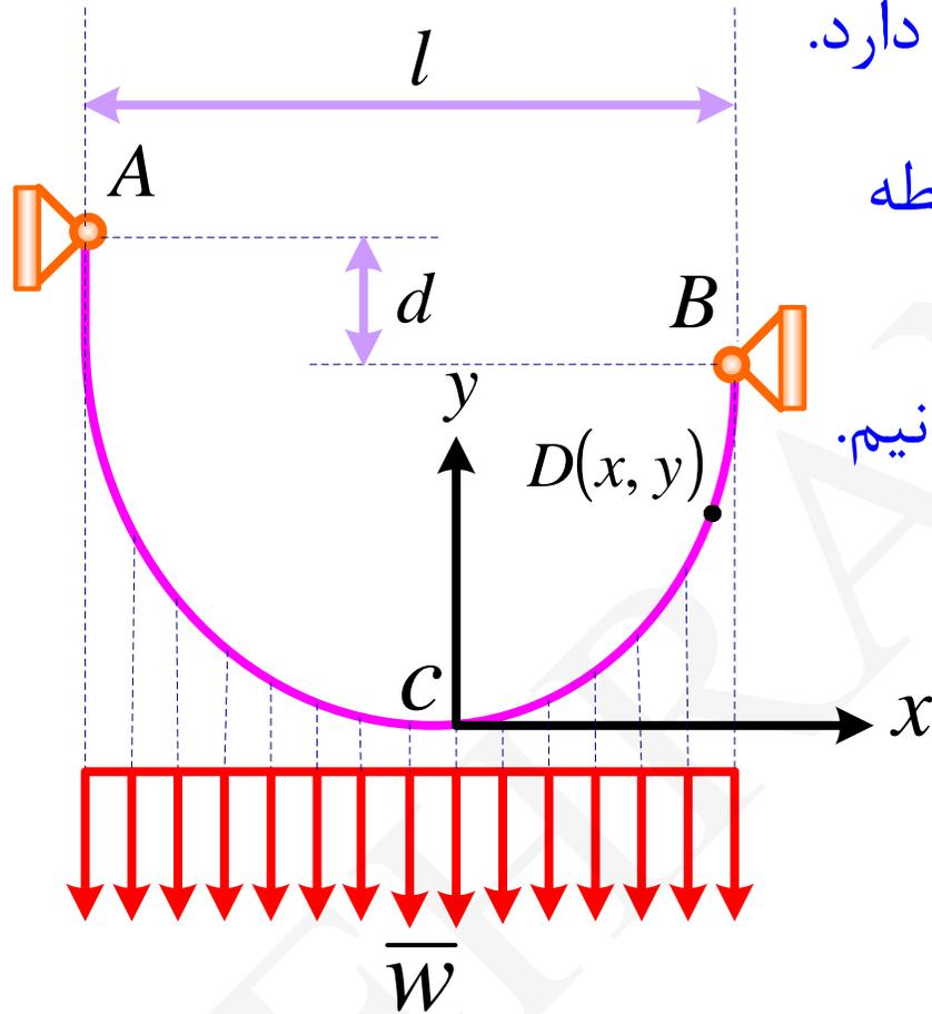
کابل تحت تاثیر نیروی توزیعی ثابتی قرار دارد.
