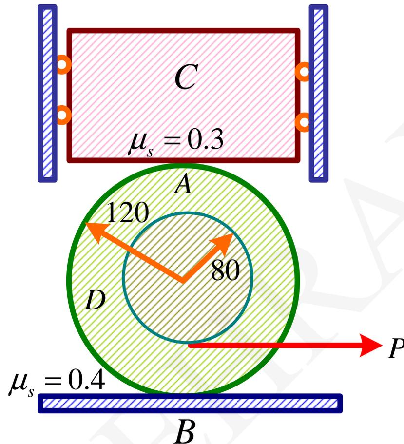
چنانچه قرار باشد تحت تأثیر نیروی P در آستانه حرکت باشد می تواند به صورت لغزش در A و غلتش در B و یا به صورت غلتش در A و لغزش در B باشد.
