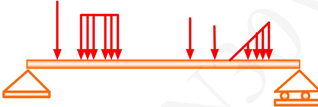
قبل از هر اتفاق جدید و بعد از آن یک برش لازمست. برای هر نیروی توزیعی هم یک برش لازمست.
