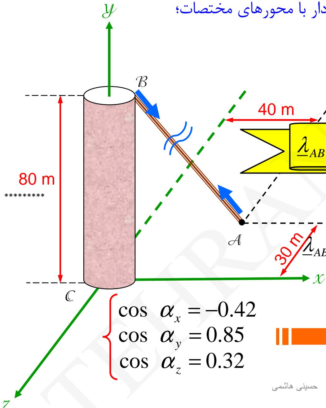
**مثال:** یک دیوار سیمانی بطور موقت بوسیله کابل های نشان داده شده در شکل نگهداری شده است. کشش در کابل AC برابر 1200 N و در کابل AB برابر 840 N است. مطلوبست: بزرگی و جهت برآیند نیروهای کابل AB و AC در نقطه A
