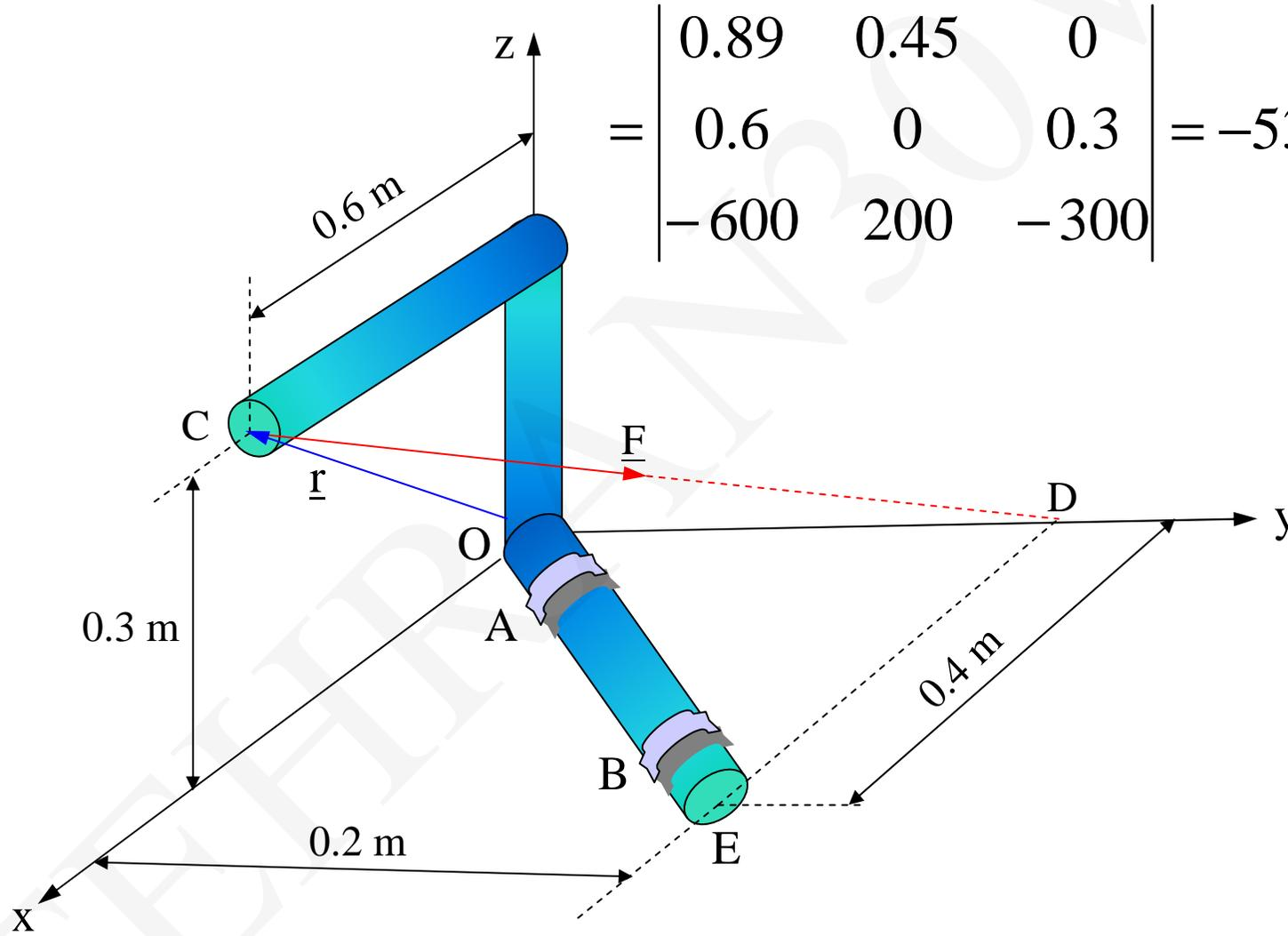
مثال: سیستم نشان داده شده در شکل را با یک نیرو و بردار کوپل در نقطه O تعویض کنید.
