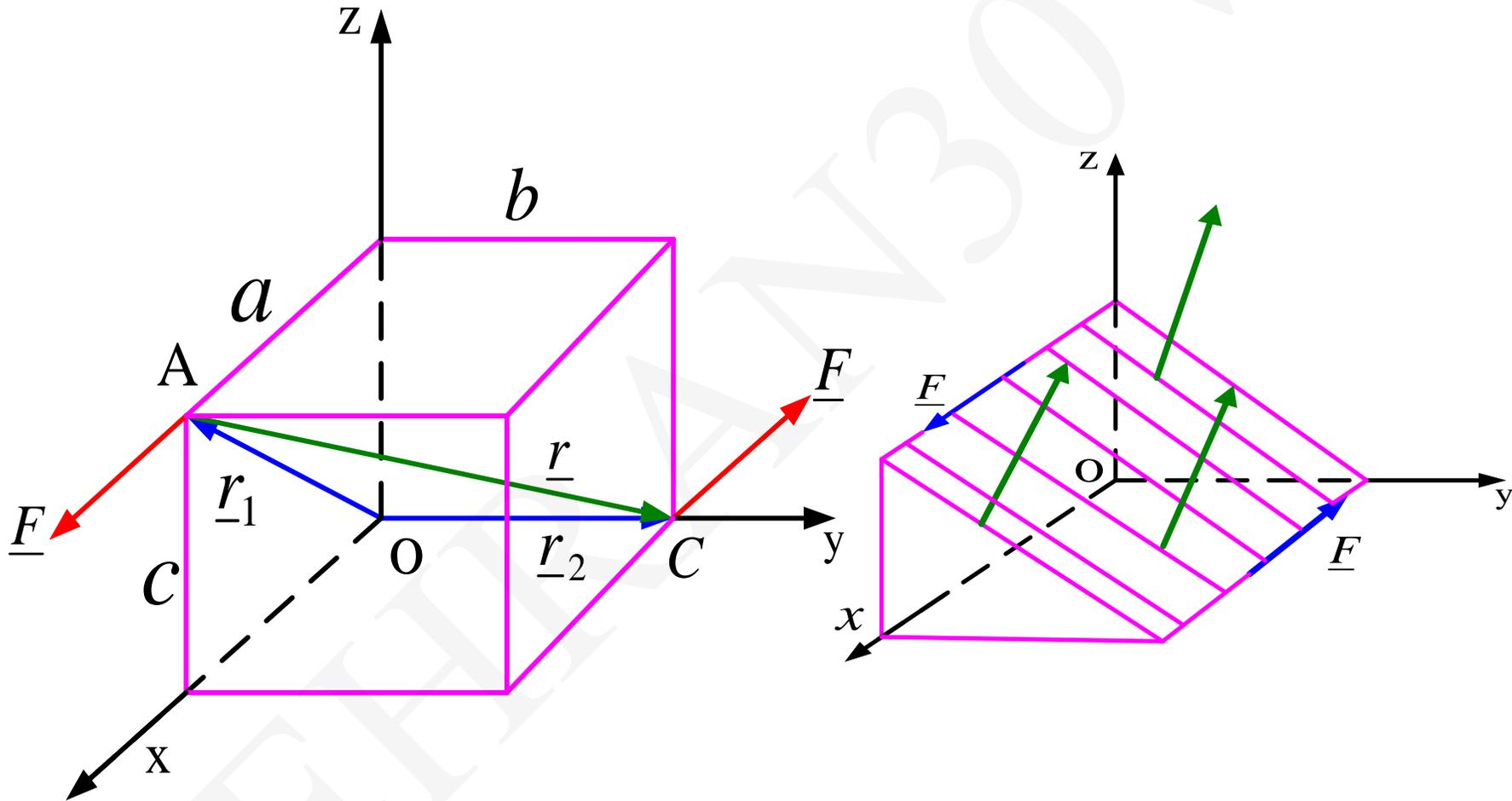
تجزیه (تعویض) یک نیروی مفروض به یک نیرو و بردار کوپل در نقطه ای مثل O
