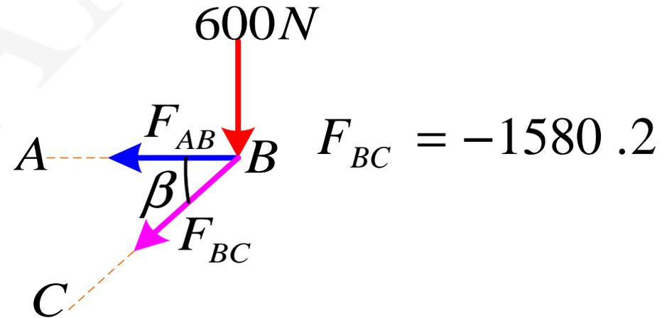
مثال: برای ترانس نشان داده شده در شکل نیروهای داخلی را در هر یک از اعضا مشخص کنید.
