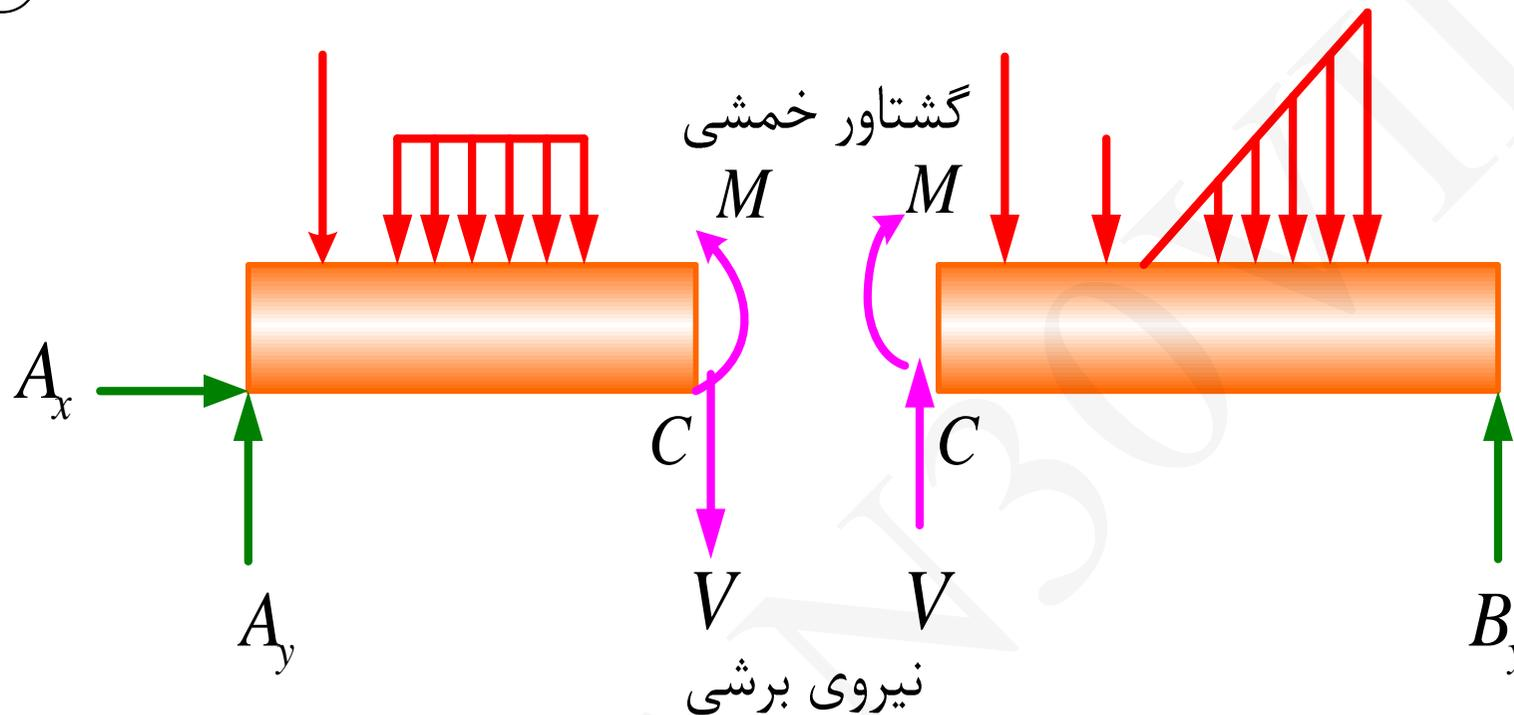
چنانچه جهت نیروی برشی و گشتاور خمشی مطابق شکل باشد برش و خمش را مثبت می نامند.
