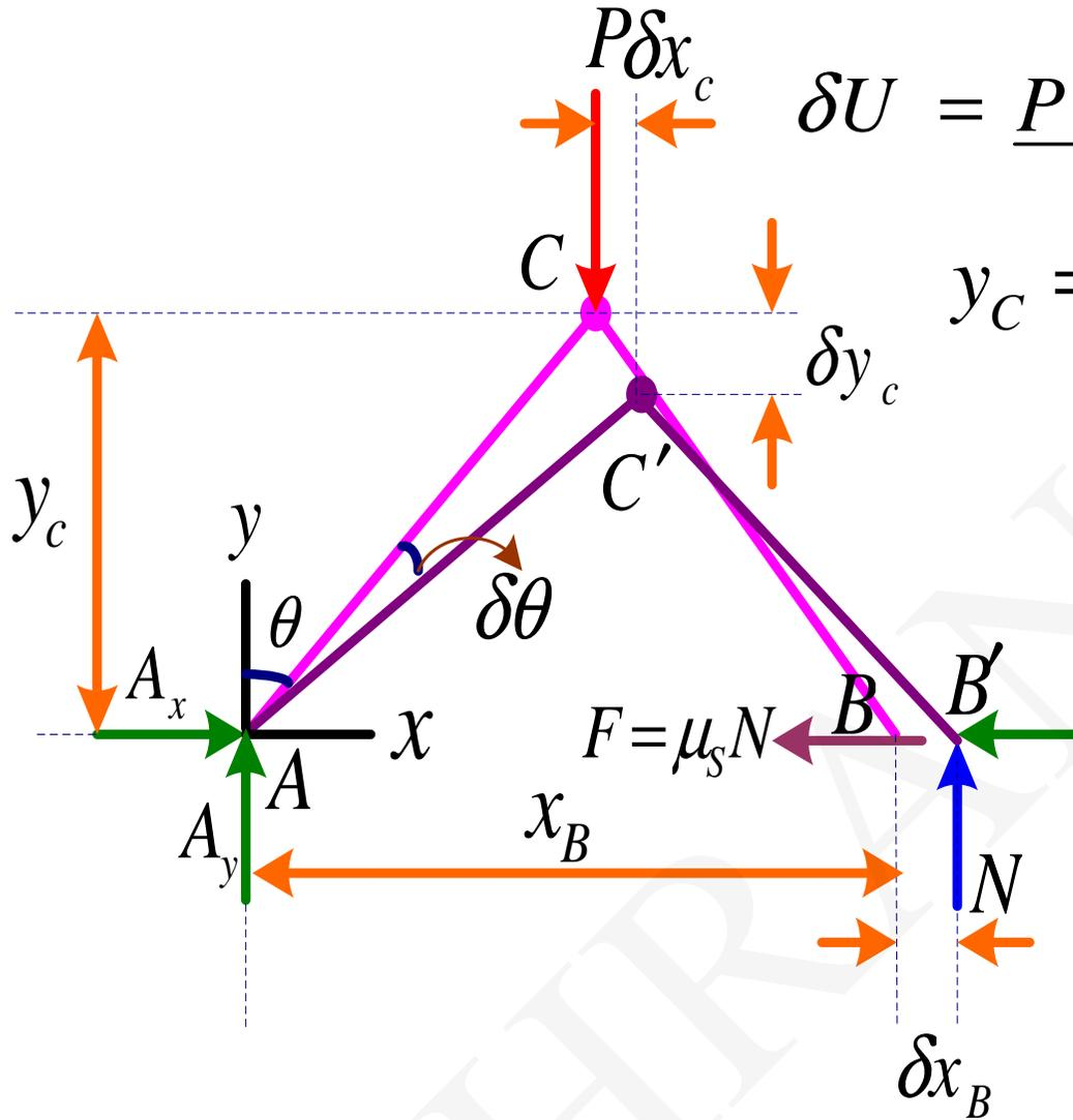
$$\delta U = \underline{P} \cdot \delta \underline{y}_C + \underline{F} \cdot \delta \underline{x}_B + \underline{Q} \cdot \delta \underline{x}_B$$
