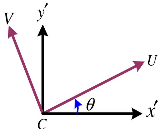
$$I_U = \frac{I_{x'} + I_{y'}}{2} + \frac{I_{x'} - I_{y'}}{2} \cos 2\theta - I_{x'y'} \sin 2\theta$$
