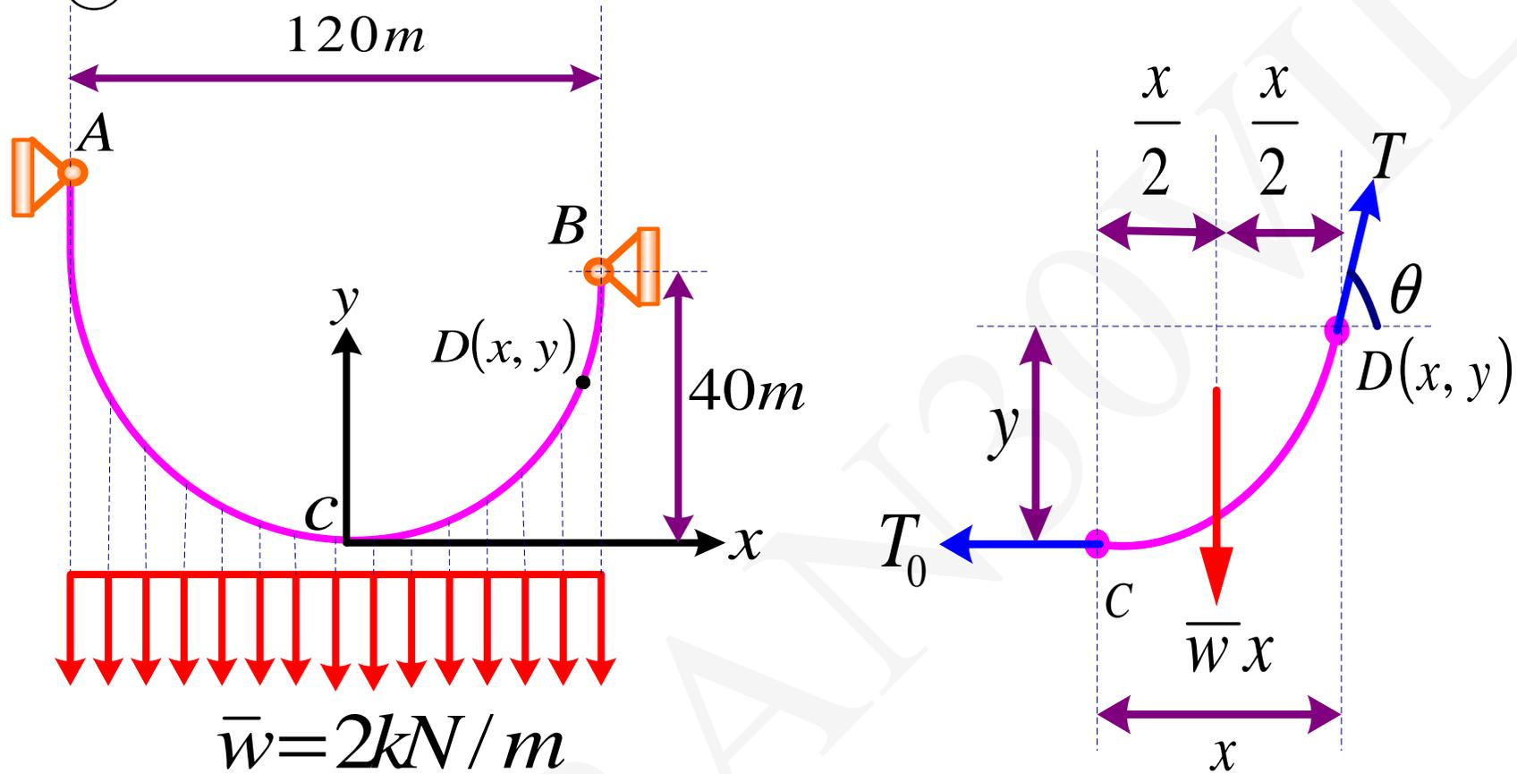
$$\sum M_D = T_0 y - \bar{W} x \left( \frac{x}{2} \right) = 0 \Rightarrow y = \frac{\bar{W}}{2T_0} x^2 \quad \text{نمایشگر سهمی است}$$
